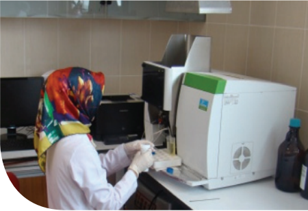
AAS Sistemi Perkin Elmer Analyst 400
