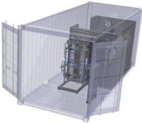
Fotoğraf 28 Zeolit tüpleri, konteyner yerleşimi
