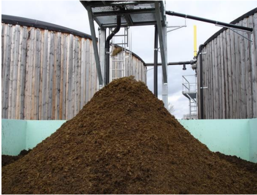
Fotoğraf 49 Seperatörden geçmiş sindirilmiş bulamaç, katı kısım
