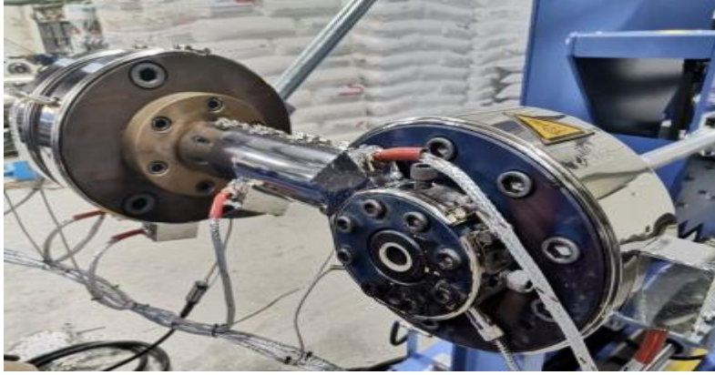
Şekil 16: Yuvarlak Damlama Ekstruder Boru Kafası
